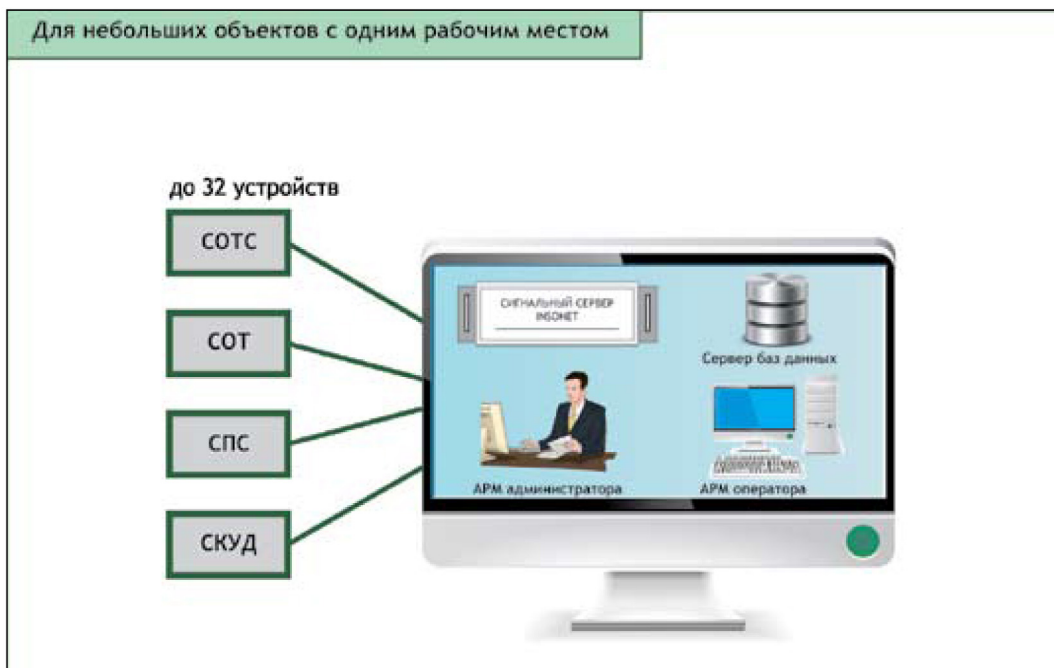
Рис. 2. Варианты построения ПК «Insonet» для небольших объектов с одним рабочим местом
